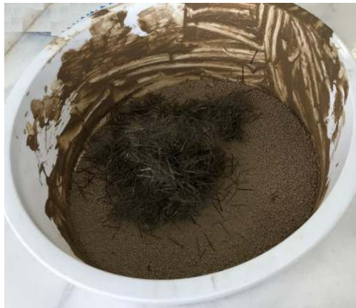
Şekil 2. Silt numune ve bazalt fiber lifleri karıştırma işleminden önceki hali
