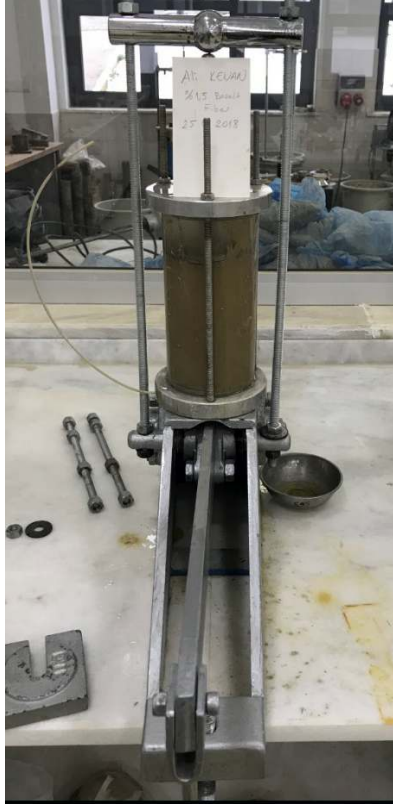
Şekil 3. Numunelerin bulamaçtan 100 kPa düşey gerilme altında yeniden oluşturulması
